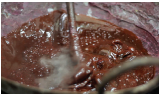
Fig. 9A: Melting the raw solid lacquer pieces
