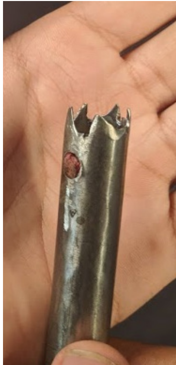
16mm dia, 5 teetch blade edge
