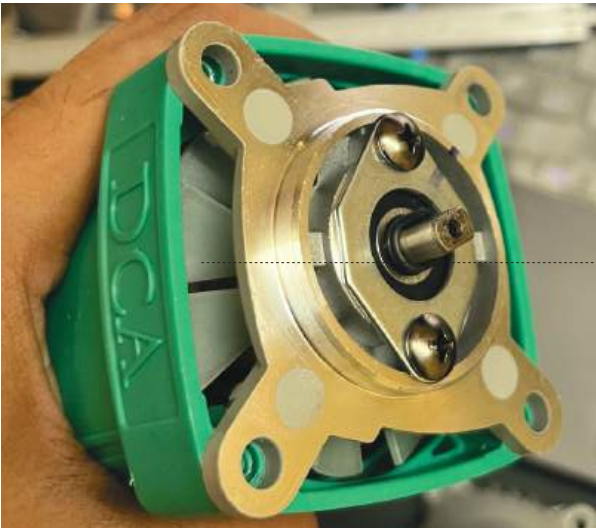
Fig 15.1: Fan For Motor Ventilation
